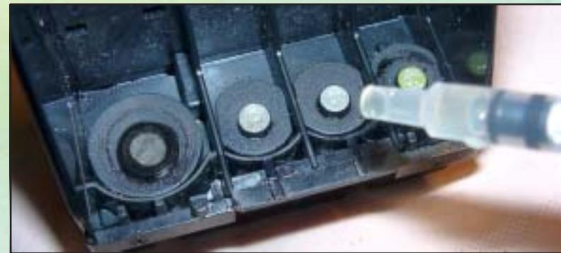
Retourner la tête d'impression et poser là sur du papier absorbant. A l'aide de la pipette, déposer du liquide de nettoyage sur les petites grilles situées à l'emplacement des cartouches, laisser agir quelques minutes. Le liquide doit disparaître dans les grilles pour nettoyer complètement la tête d'impression. Tamponner avec un papier absorbant et remonter l'ensemble tête d'impression puis cartouches dans l'imprimante.
