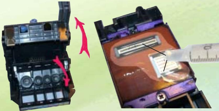
Retirer les cartouches et la tête d'impression de son logement. A l'aide de la pipette, déposer quelques gouttes de liquide de nettoyage sur les buses situées sous la tête d'impression, laisser agir quelques minutes, le liquide doit disparaître dans les buses et ressortir par dessous. Renouveler l'opération 2 ou 3 fois si nécessaire. Passer à l'étape suivante, même si le liquide ne pénètre pas.
